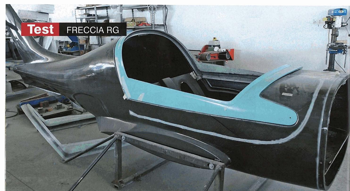
**Assemblage des deux demi-coques. Des renforts latéraux sont fixés sous les sièges ainsi qu'au niveau du plancher.**
