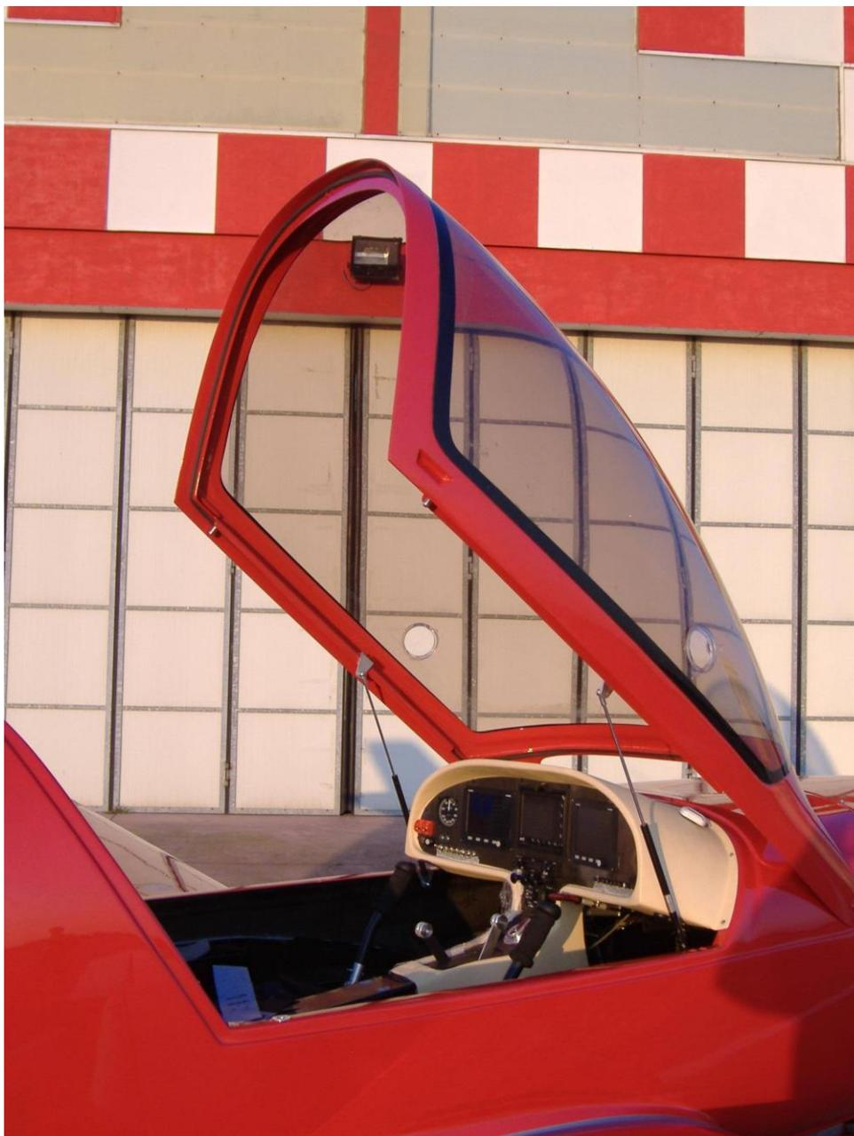
L'abitacolo è chiuso da un tettuccio in Plexiglass termoformato apribile scorrendo o alzandolo a secondo del modello.
