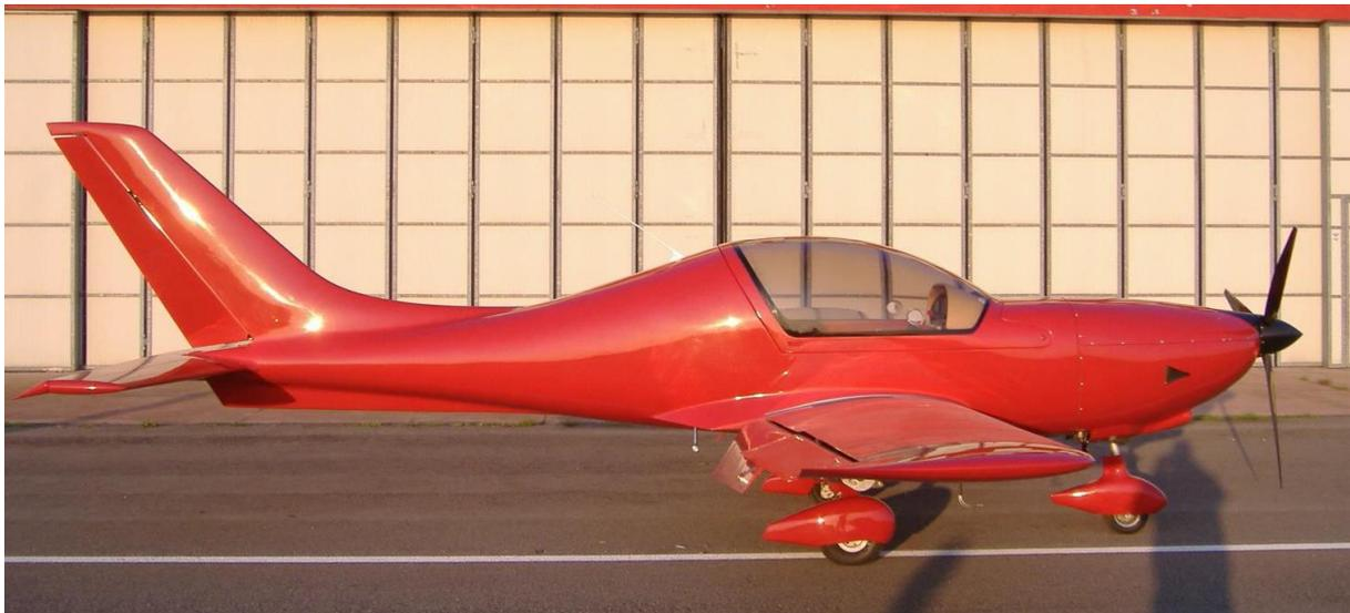
Il velivolo Freccia è un monoplano ad ala bassa, biposto, a elica traente, a composizione aerodinamica classica ed impennaggio orizzontale.
