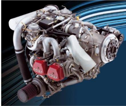
Motore: ROTAX 914 UL oppure equivalenti, a quattro cilindri, a quattro tempi, a raffreddamento combinato.
